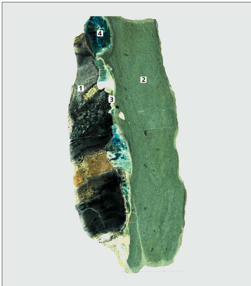
Образец дианитовой породы. Хорошо видны контакты скарнированных черносланцевых пород с отчетливо выраженной первичной слоистостью (1) и маломощной апофизой дайки темнозеленого грорудита (2), амфиболизация по зоне контакта (3) с образованием дианита (4).
